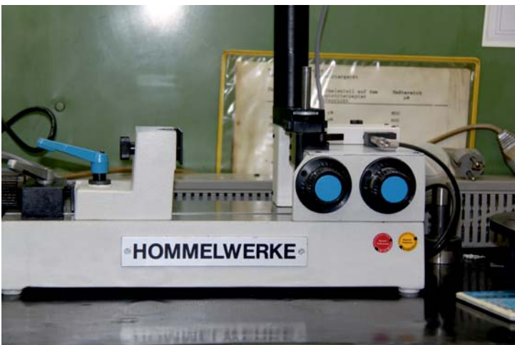
ZWG8305 komplett überholt. Führungen geschliffen, neu lackiert, digitaler Taster und neuer Antriebsmotor. Gerät wurde danach neu kalibriert.
