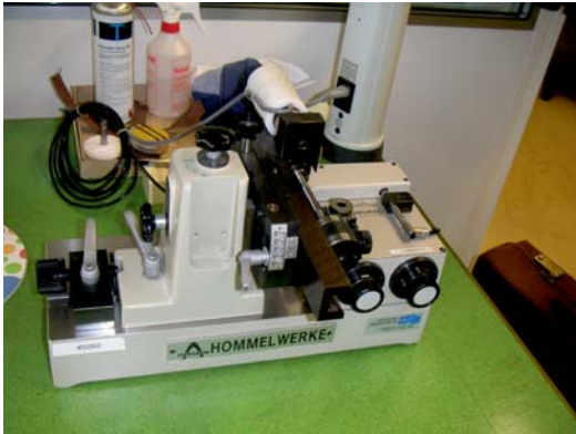
ZWG8305 Schneckenantrieb nach Retrofit mit neuem Motor und digitalem Taster.
