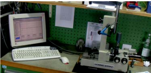
ZWG8305 nach Retrofit mit DF1 WinGear TCPIP.
